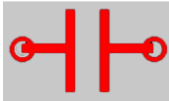
图 C. 18 串联电容图元定义-图形示例
