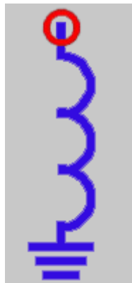
图 C. 34 消弧线圈图元定义-图形示例
