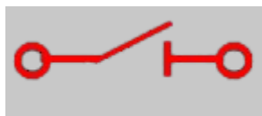
图 C.4 隔离刀闸图元定义-图形示例
