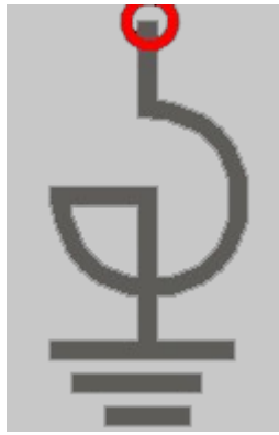
图 C.20 串联电抗图元定义-图形示例
