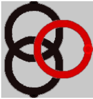
图 C.12 三卷变压器图元定义-图形示例
