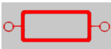
图 C.2 断路器图元定义-图形示例
